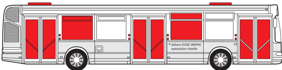
Элементы аварийных выходов
