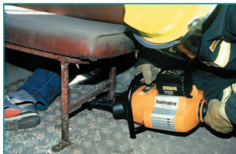
автономные аварийно-спасательные инструменты хорошо работают в стесненном помещении автобуса
