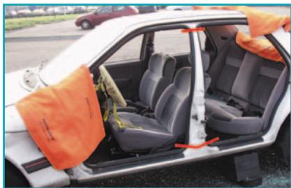
Отрезать верхнюю и нижнюю части средней стойки В автомобиля для ее удаления. Необходимо помнить об использовании средств защиты от острых кромок.
