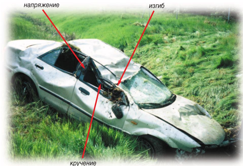
При рассмотрении возможных механических реакций (удар во время столкновения, который меняет структуру автомобиля) мы будем говорить о надежных точках опоры и об эластичных или нестабильных точках.
