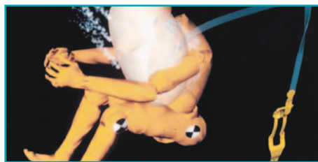
срабатывание передней подушки безопасности
