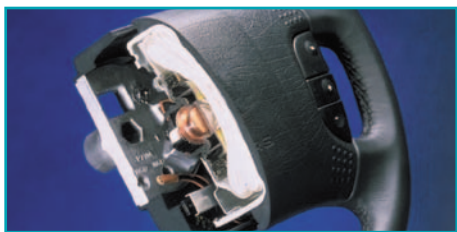
поперечное сечение неразвернутой передней подушки безопасности
