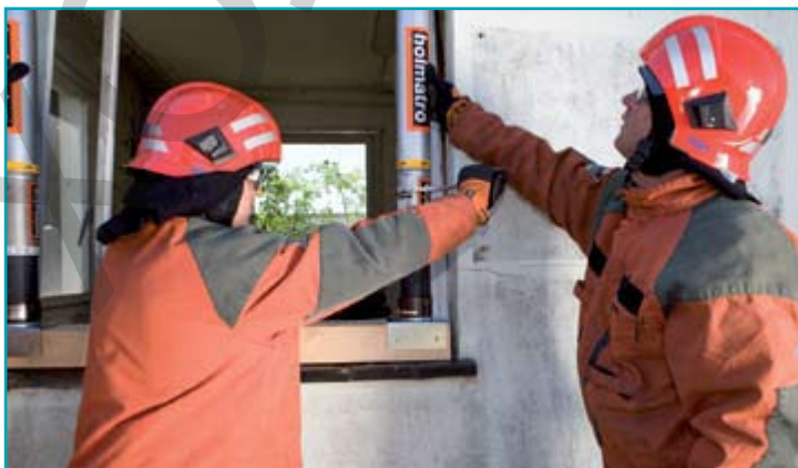
Для установки распорки не требуется сжатого воздуха или насосов
