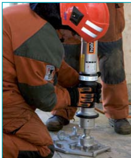
Спасатель фиксирует контргайку на распорке
