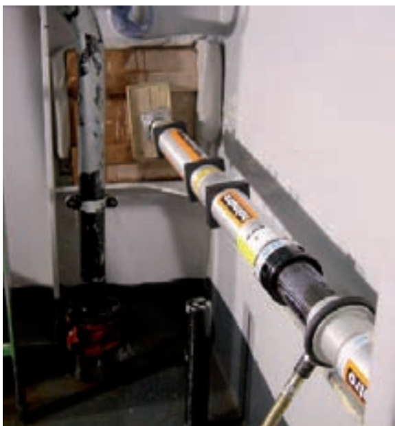
Гидравлические распорки в комбинации с удлинителями, опорами и брусом, использованы для ликвидации течи на корабле.
