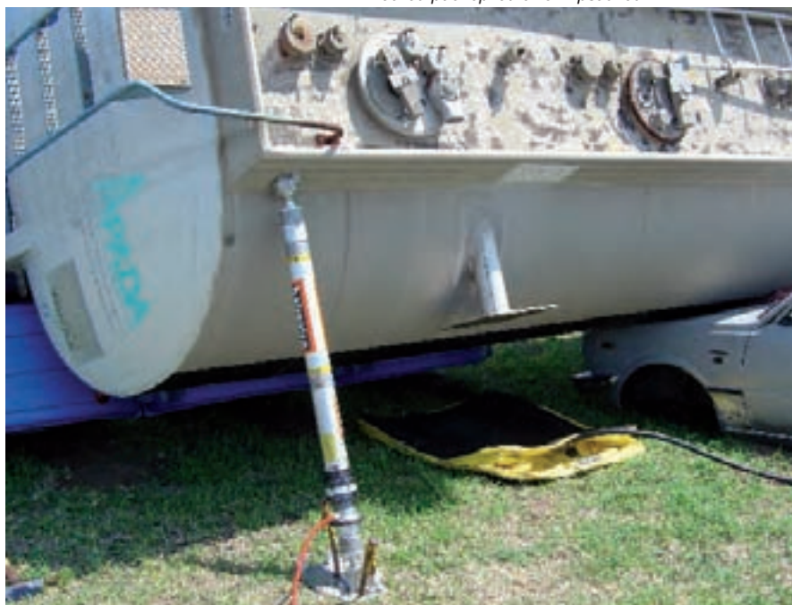
Пневматическая распорка с автоматическим фиксатором используется для вспомогательного закрепления в операциях по подъёму грузового автомобиля.
