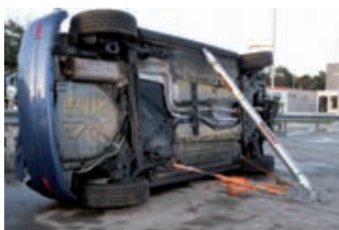
Удлинитель, головки и опоры в стабилизации легкового автомобиля.
