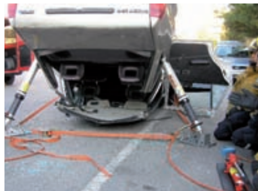
Стабилизация легкового автомобиля гидравлическими распорками с контргайками.
