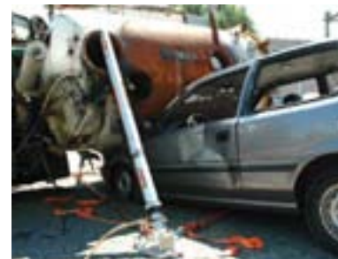
Стабилизация грузового автомобиля гидравлическими распорками с контргайками.
