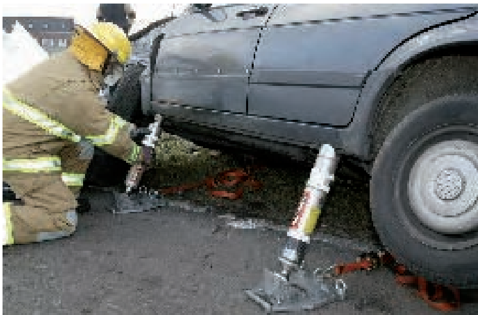
Стабилизация автомобиля при помощи ручных распорок с контргайкой.
