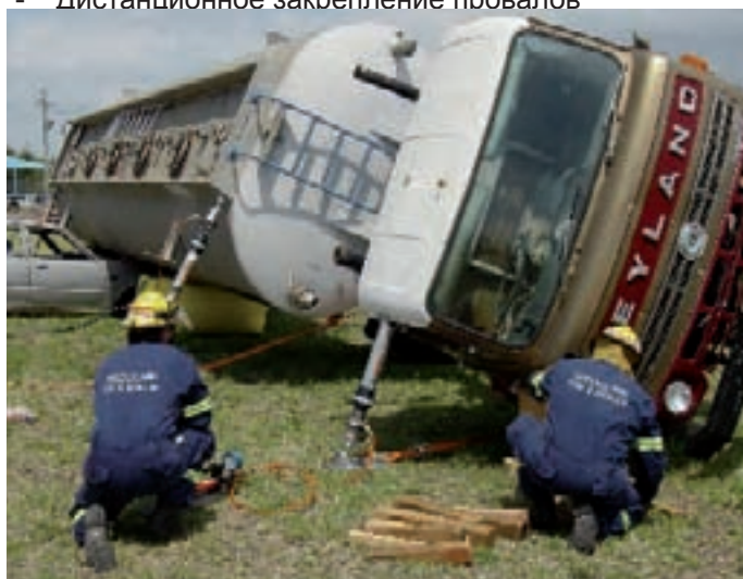
Гидравлическая распорка с автоматическим фиксатором используется для одновременного подъёма и закрепления тяжёлого автомобиля.
