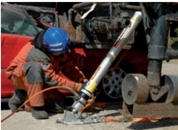
Крепы могут быть установлены под различными углами.
