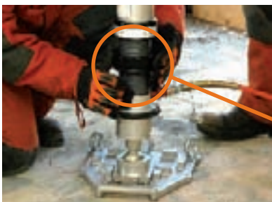
Груз фиксируется вручную контргайкой.
